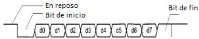
Figura A.5: Formato de las señales de comunicación en UART .
